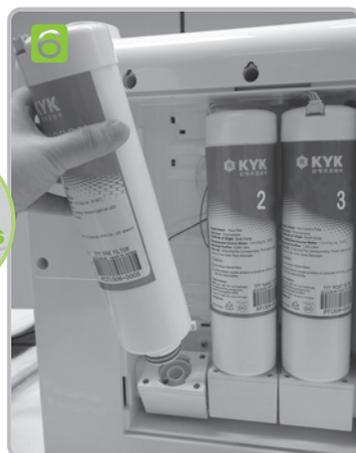
Поверните фильтр против часовой стрелки и вытащите.
